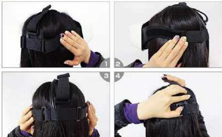
片手でFOVEを固定したまま、左右のバンドをゆるめに締め、徐々に左右のバンドを締めて固定してください。最後に頭頂部のバンドを締めてください。
